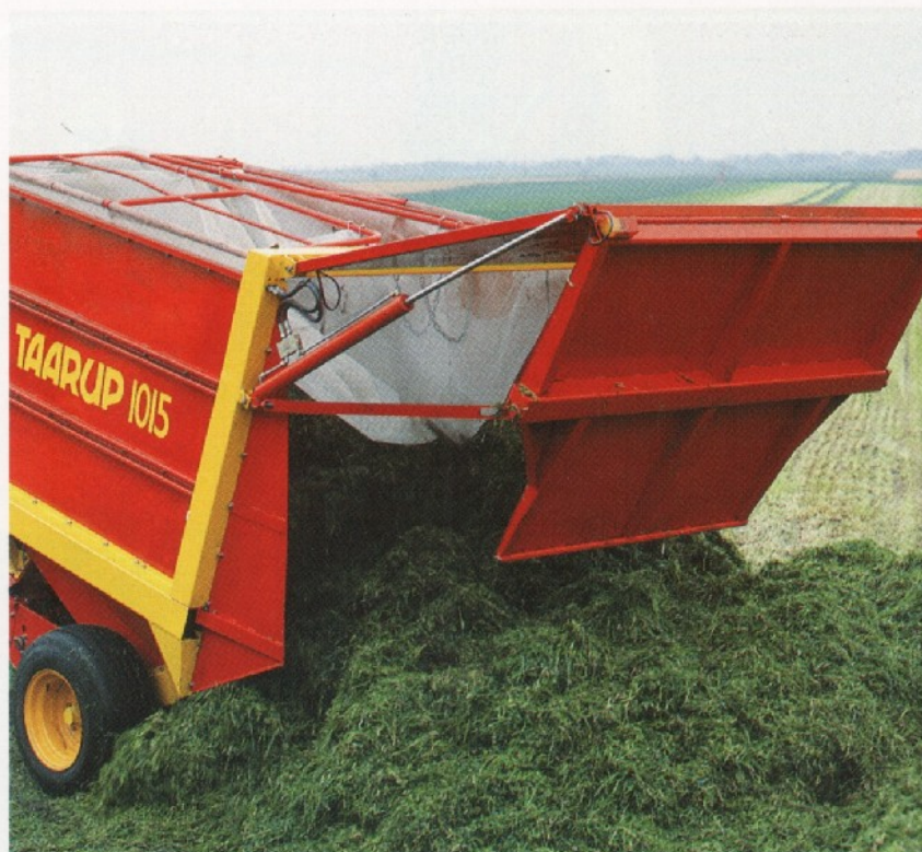
Door het openen van de achterwand en het kippen van de wagen via de driepunts ophanging van de trekker, valt het materiaal gewoon uit de wagen.
