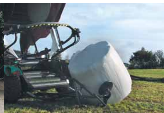
Een hydraulisch te bedienen baalkeerder (optie) zorgt ervoor dat de balen op hun zijkant worden gelegd, zelfs op een helling.
