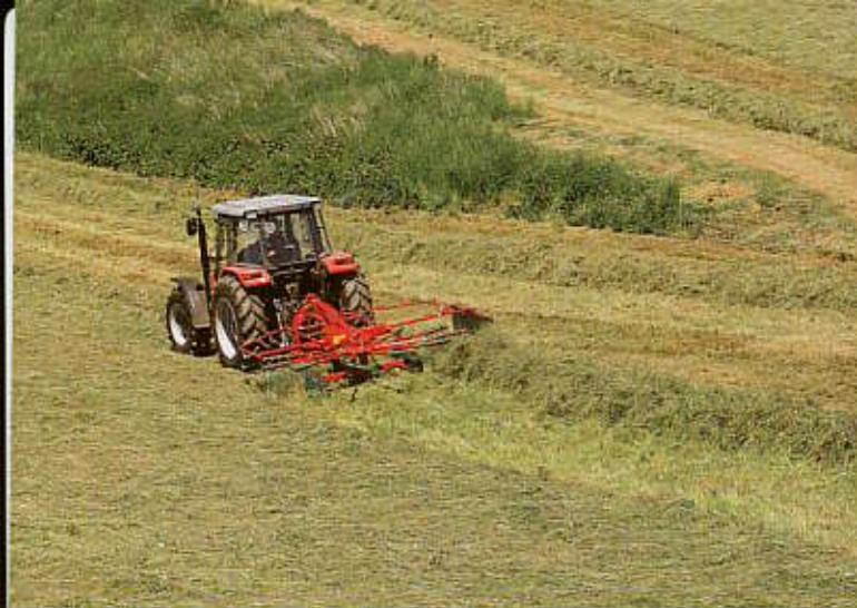
Taarup 9039 met een werkbreedte van 3,9 m met 11 afneembare tandarmen, allen voorzien vier Duo Tandem.
