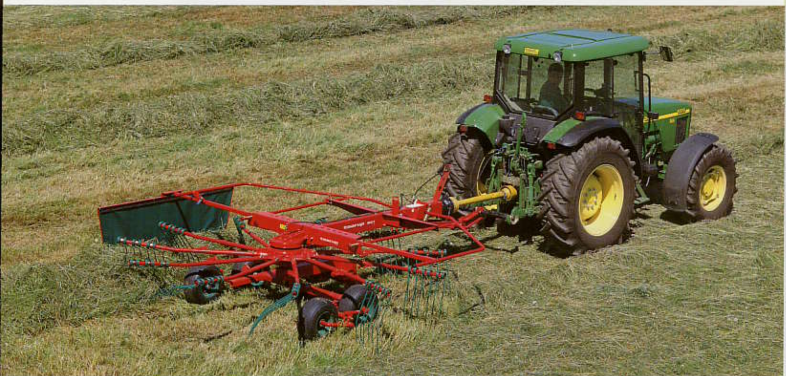
Taarup 9042T getrokken cirkelhark, werkbreedte 4.2 m.
