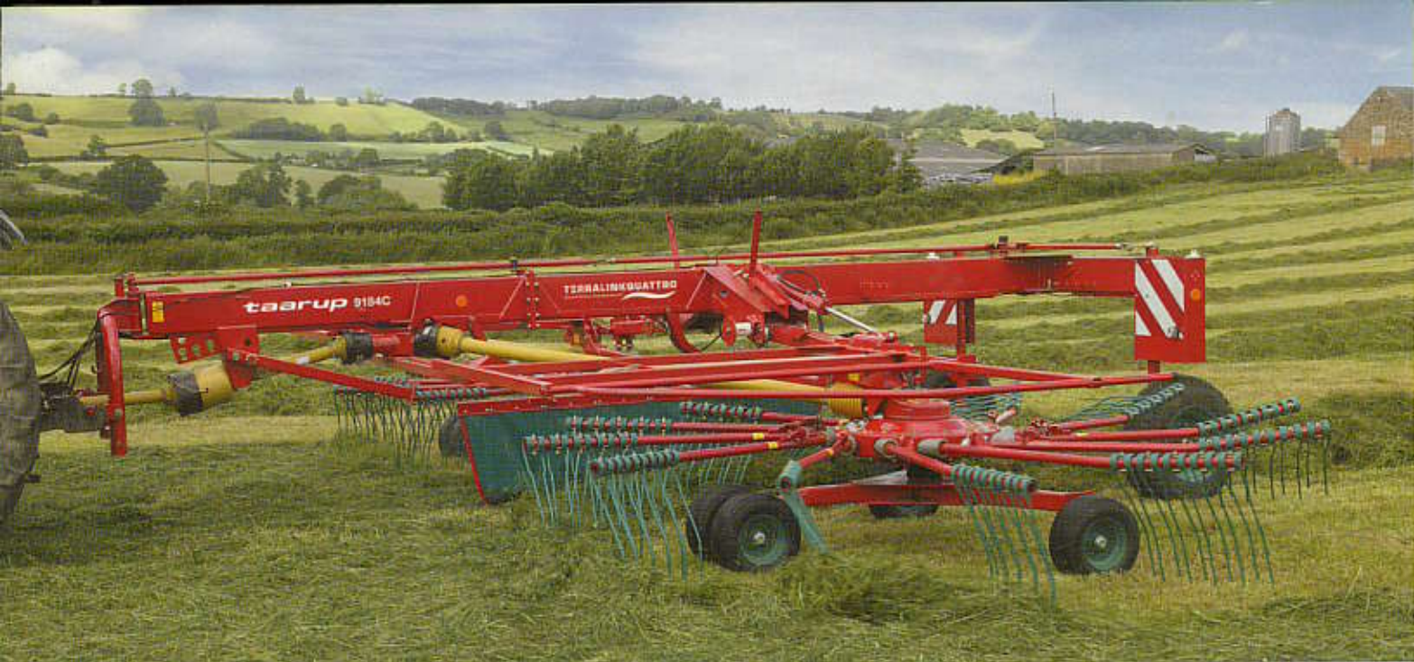
Taarup 9184C met een werkbreedte van 8,4m en 5 Duo Tandem aan elke tandarm.
