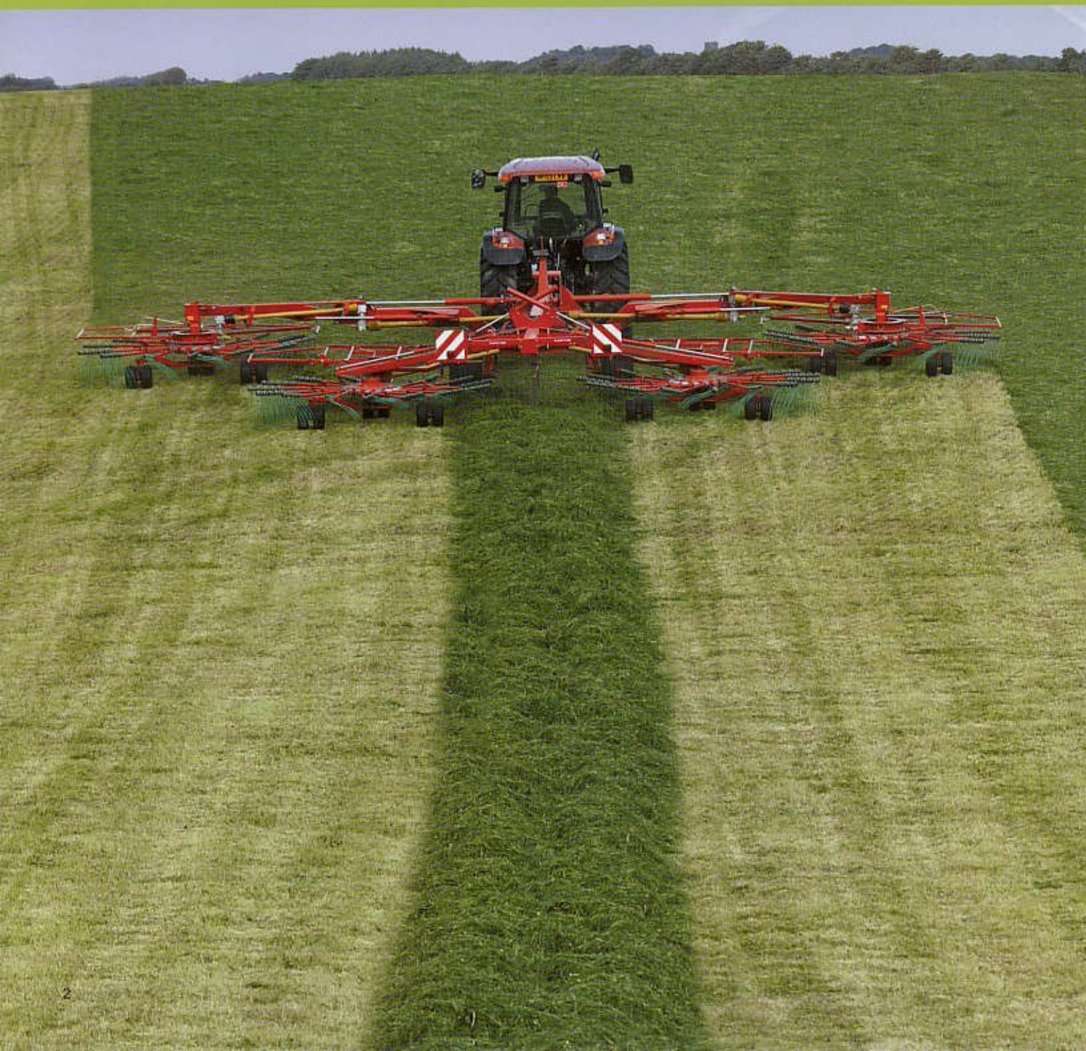
Taarup 91150C vier-elementen hark met een werkbreedte van 15 m.
